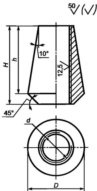
Рисунок 15 — Коническая втулка (поз. 16 на рисунке 1)
