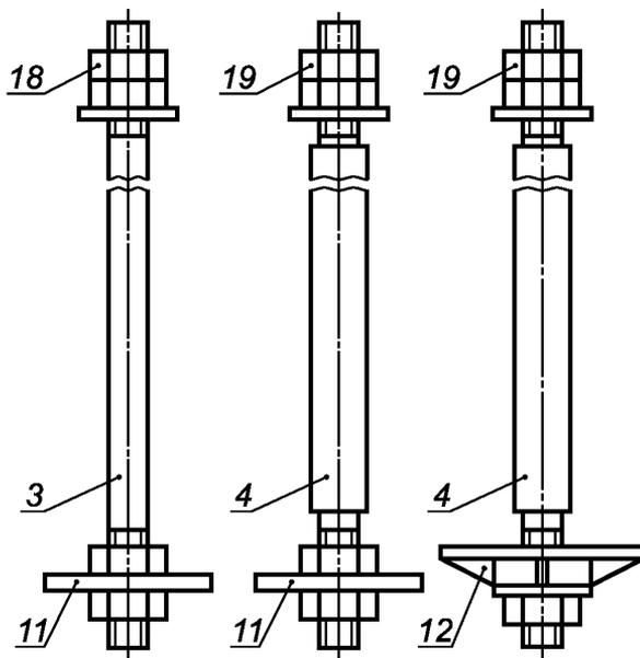
Рисунок 1 — Типы и конструкция фундаментных болтов, лист 1
