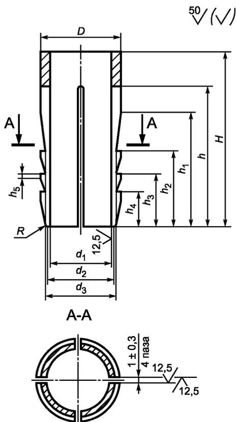
Рисунок 14 — Разжимная цанга (поз. 15 на рисунке 1)
