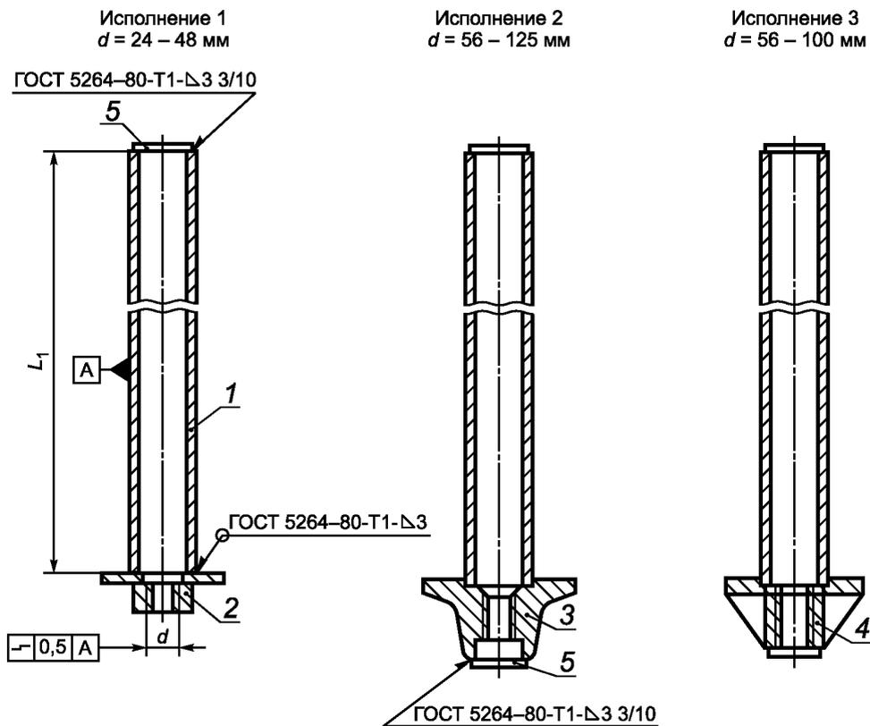
1 — труба (см. рисунок 7); 2 — составная анкерная плита (см. рисунок 8); 3 — литая анкерная плита (см. рисунок 9),
